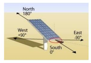
Inclination (tilt) of a PV module
